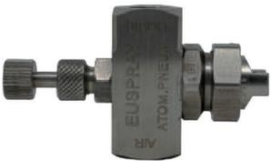
Ha le stesse caratteristiche dell'ugello E1 con la possibilità di chiudere del tutto o parzializzare l'ingresso del liquido, grazie alla presenza di un ago di regolazione posto sulla parte posteriore del corpo.
