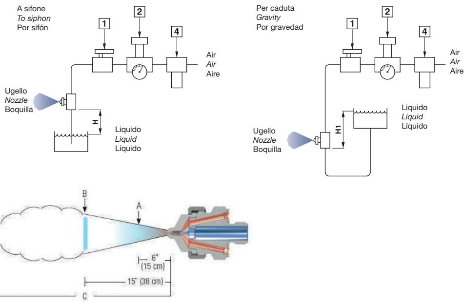
I set-up di miscelazione esterna sono ideali per liquidi viscosi o che tengono solidi sospesi. Le dimensioni A e B mostrano le coperture alle diverse distanze, oltre la distanza C il getto diventa frastagliato.
