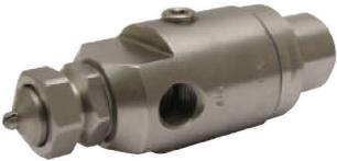
Il modello PA1 ha connessioni femmina da 1/4" per l'aria e il liquido da nebulizzare, e connessione femmina da 1/8" per l'aria di pilotaggio del pistone interno per operazioni di ON-OFF.
